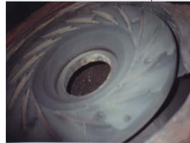
被腐蚀的离心机叶片
