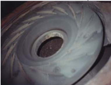
被腐蚀的离心机叶片
